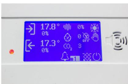
Este comando de parede **pode gerir até 32 recuperadores de calor ASPIRNOVA série RCE-EC-DP** através de uma ligação em série utilizando o protocolo Modbus RTU, através da entrada RS485, disponível tanto nos recuperadores como no comando. Além disso, graças à ligação através de Modbus, estes equipamentos podem integrar-se em sistemas de gestão BMS para uma regulação superior.
