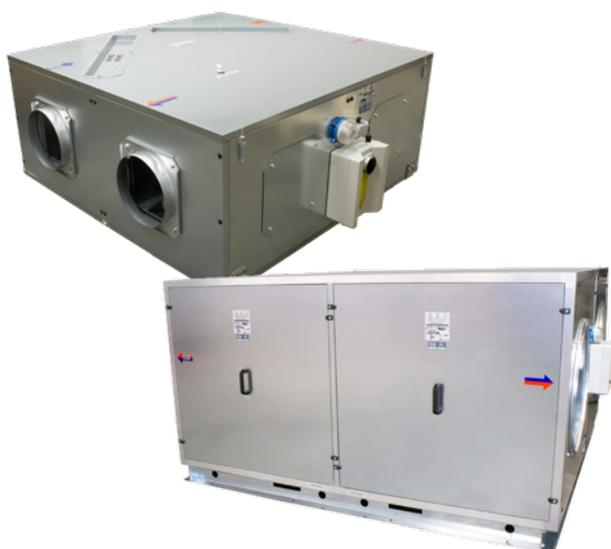
A série de recuperadores de calor **ASPIRNOVA RCE-EC-DP** está disponível em versões horizontal e vertical. Em ambas as configurações, os equipamentos são fabricados com painéis sanduiche isolados, de 25mm, usando poliuretano (PU) ou lã mineral. A partir do modelo RCE 7100, acrescenta-se uma estrutura tubular de alumínio estruído para maior robustez.
