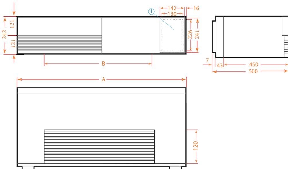
(1) Paneles desmontables, uno por cada lado, para las conexiones hidráulicas
