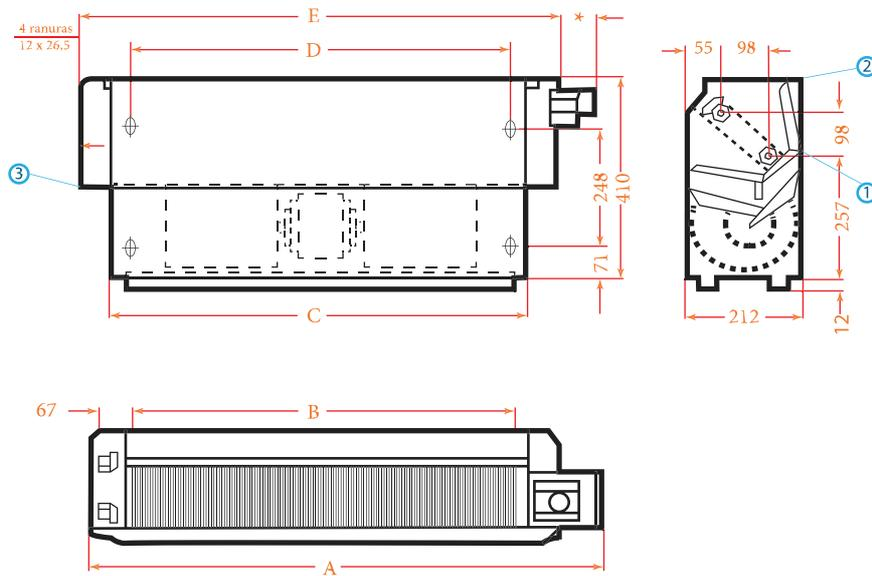
El plano representa la unidad con conexiones hidráulicas a la izquierda:
