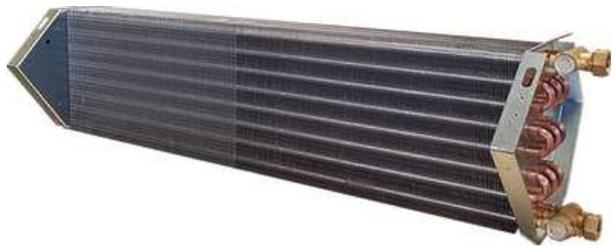
Las conexiones al circuito hidráulico son con rosca gas hembra 1/2". Los colectores tienen manguitos roscados para purgado de aire y para el drenaje de métrica 6 de asiento cónico.
