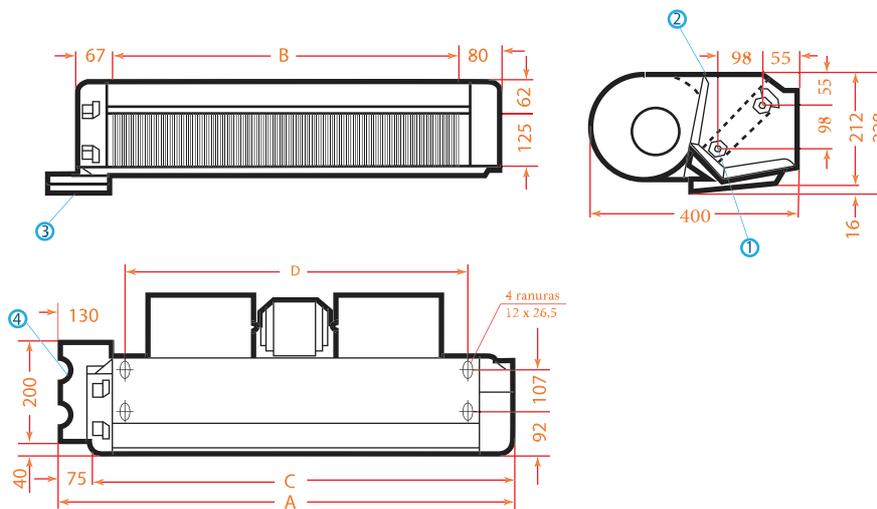
El plano representa la unidad con conexiones hidráulicas a la izquierda:
